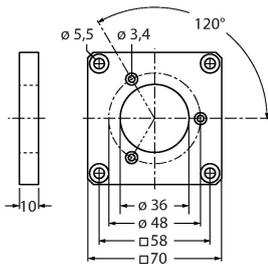
Quadratischer Flanschadapter aus Aluminium für Vollwellendrehgeber mit Klemmflansch; Kantenlänge 70 mm; 10 mm Stärke
