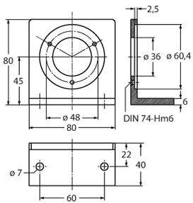
Winkelflansch aus Aluminium für Vollwellendrehgeber mit Klemmflansch Ø 58 mm
