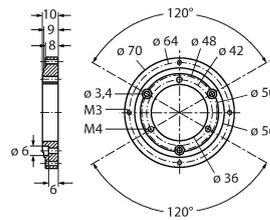
Flanschadapter aus Aluminium für Vollwellendrehgeber mit Klemmflansch, Ø 70 mm, 10 mm Stärke; zur Adaption an Flansche mit Ø 70 mm
