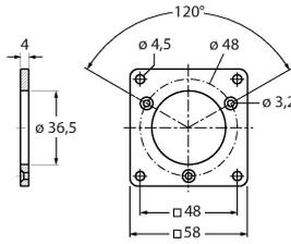
Quadratischer Flanschadapter aus Aluminium für Vollwellendrehgeber mit Klemmflansch; Kantenlänge 58 mm; 4 mm Stärke
