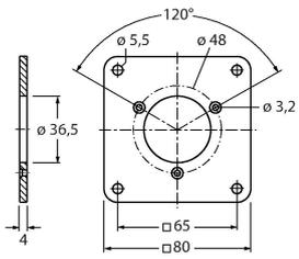
Quadratischer Flanschadapter aus Aluminium für Vollwellendrehgeber mit Klemmflansch; Kantenlänge 80 mm; 4 mm Stärke
