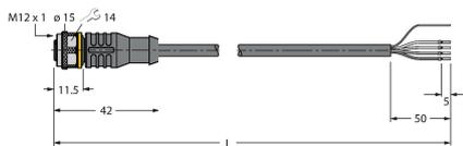
Busleitung für CAN (DeviceNet, -CANopen), M12-Kupplung, gerade, Leitungslänge: 5 m, Mantelmaterial: PUR, anthrazit; cULus-Zulassung
