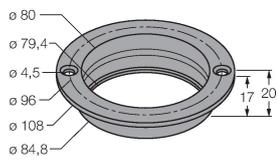
Der Flansch ermöglicht die Montage des Datenträgers TW-R80-M-B128 (-K2) auf oder in Metall.
