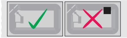
Defekte Datenträger werden durch einen schwarzen Punkt gekennzeichnet. Diesen Datenträger bitte nicht verwenden. Bei der Lieferung wird die Anzahl der als defekt markierten Datenträger zur Gesamtzahl an gelieferten Smart-Labels addiert.
