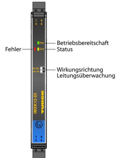
An den 1-kanaligen Trennschaltverstärker IMXK12-DI01-1S-1R-0/24VDC/CC können Sensoren nach EN 60947-5-6 (NAMUR) oder potenzialfreie Kontakte angeschlossen werden. Das Gerät ist mit einem eigensicheren Eingangskreis ausgestattet und kann in Zone 2 montiert werden. Der Ausgangskreis ist mit einem Umschalter-Relais ausgestattet. Das Gerät erfüllt die Anforderungen der NE21.
