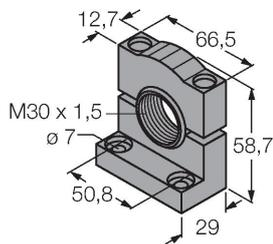
Montagehalterung, PBT-schwarz, für Sensoren mit 30-mm-Gewinde, ausrichtbar
