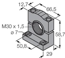
Montagehalterung, PBT-schwarz, für Sensoren mit 30-mm-Gewinde, ausrichtbar
