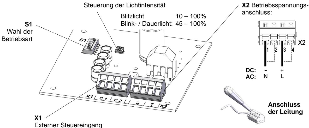
**Hinweis:** Geräte mit DC-Spannung sind mit einem Verpolungsschutz ausgerüstet. Bei Verpolung der Anschlüsse keine Funktion.
