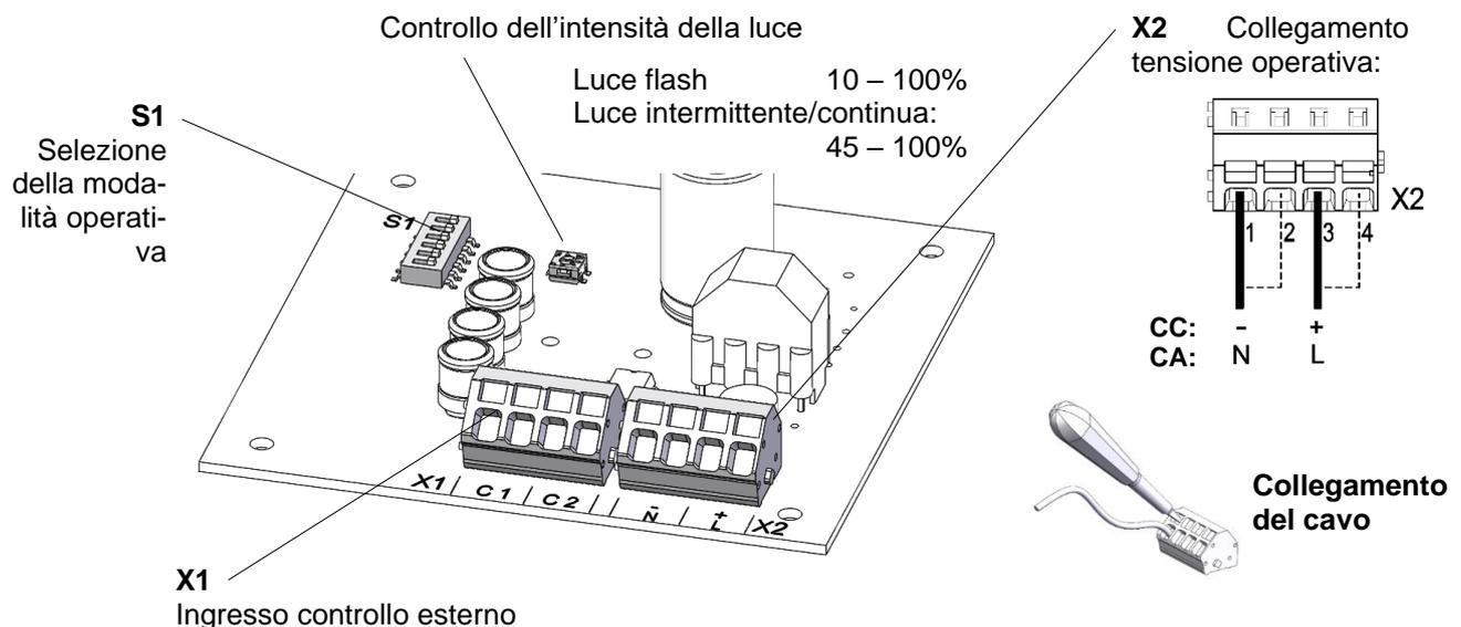
**Nota:** Gli apparecchi in cc sono dotati di protezione da inversione di polarità. In caso di inversione di polarità il funzionamento è garantito.
