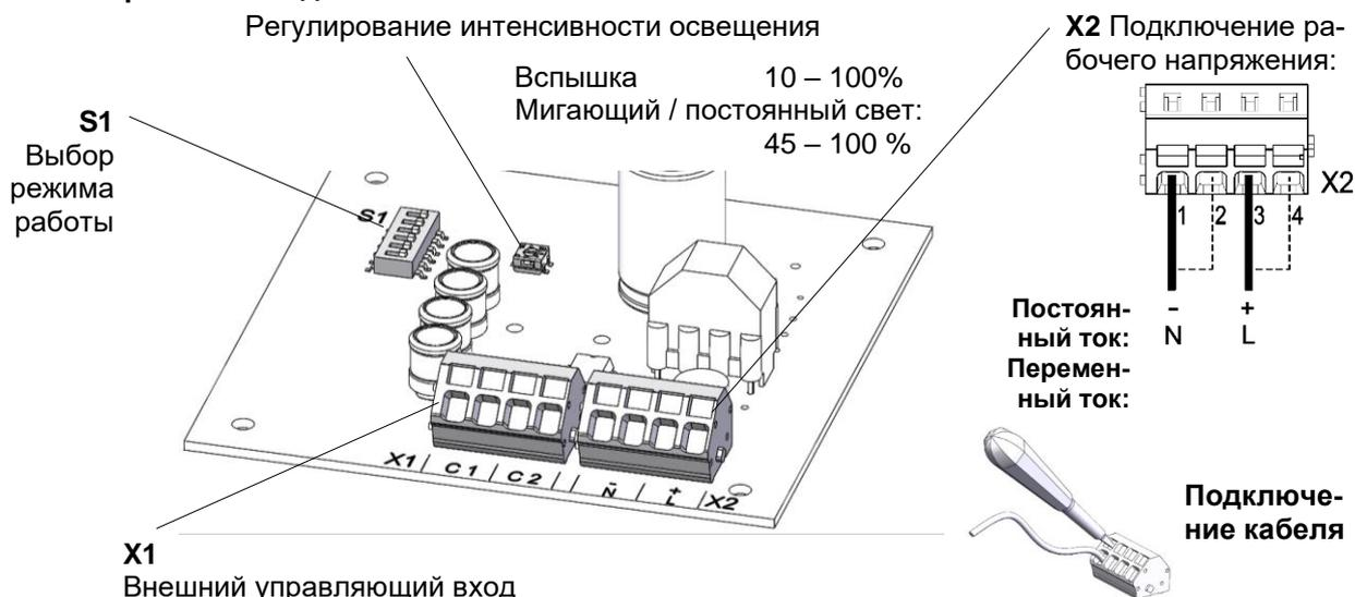
**Указание:** Устройства, работающие от напряжения пост. тока, оснащены защитой против инверсии полярности. При неправильной полярности подключения гарантируется функционирование устройства.
