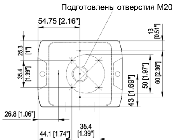
Схема расположения отверстий внутри корпуса (РА 1)
