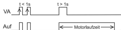
Eingestellter Jalousiegegenlauf (tg): Gegenlauf wird durch Zeitablauf von VZ oder durch manuellen Stopp mit VA bzw. VZ ausgelöst.
