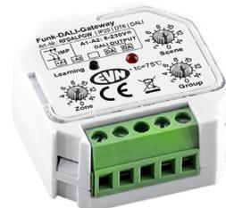
Das Funk-DALI Gateway mit manueller Gruppen-/Szenen-/Zoneneinstellung kann mit verschiedenen Funk-Dimmer-Steuerelementen mit 868 MHz, aber auch über einen Taster (8V bis 230V/AC/DC) angesteuert werden. Somit können unterschiedliche DALI-Steuerungen für Unicoloranwendungen bequem über Funk gesteuert werden. Die Stromversorgung des Gateways erfolgt über den DALI-BUS. Die Maße sind: LxBxH: 45m x 46mm x 22mm, Protokoll: DT6.
