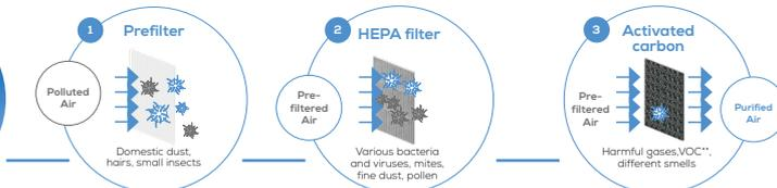
Funktionsweise des Luftreinigers: Hausstaub, Tierhaare, Gerüche, Pollen, schädliche Gase sowie diverse Bakterien und Viren werden mit Hilfe eines dreischichtigen Filtersystems aus der Luft gefiltert.
