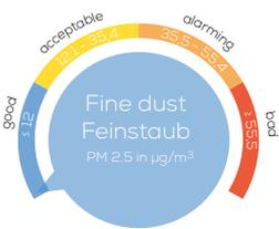
**Smart Sensor - erkennt Partikel mit einer Größe von 2,5 µm**
