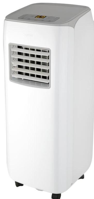
Monoblock Klimagerät zur Innenaufstellung mit Entfeuchtungsfunktion und 3 Lüfterstufen. Zur Klimatisierung von Büro- oder Privaträumen. Das im Kühl- oder Entfeuchtungsbetrieb anfallende Kondensat wird verdampft und mit der Abluft nach außen geleitet. Das Klimagerät kann durch das LED-Display auf der Oberseite des mobilen Klimagerätes oder per mitgelieferter Infrarotfernbedienung bedient werden. Geeignet für Raumvolumen bis ca. 65 m<sup>3</sup>.
