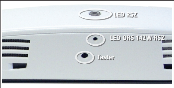
Abb. 23 Signalisierung am Gehäuseoberteil
