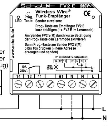
Die Empfänger-LED blinkt kurz grün nach Empfang eines Funksignals (leuchtet jedoch rot bei Lernmode, der Lernmode wird mittels Prog.-Taste ein- und ausgeschaltet)
