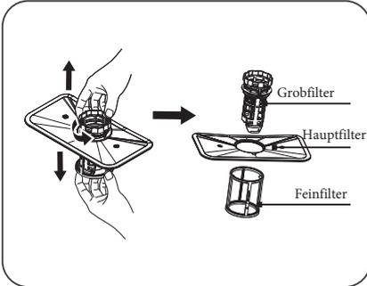
Das Filtersystem besteht aus einem groben Filter, dem Hauptfilter und dem feinen Filter (Mikrofilter).
