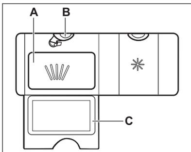
1. Drücken Sie die Entriegelungstaste (B), um den Deckel (C) zu öffnen.
