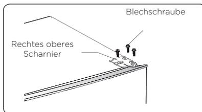
4. Entfernen Sie die Achse des oberen Scharniers. Setzen Sie diese sodann in das gegenüberliegende Scharnier und befestigen Sie sie.
