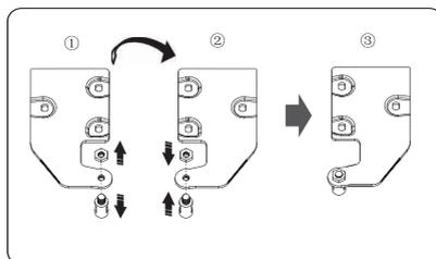
5. Nehmen Sie die obere Gerätetür vom mittleren Scharnier ab, indem Sie diese vorsichtig anheben und senkrecht nach oben ziehen.
