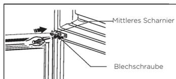
14. Setzen Sie die obere Tür in der entsprechende Position ein. Prüfen Sie, ob die Tür entsprechend ausgerichtet ist (in waagrechter Position) und setzen Sie die Achse des mittleren Scharniers in die Bohrung an der Unterseite der oberen Tür ein.
