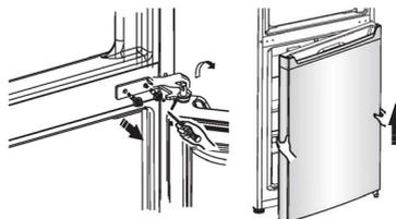
8. Legen Sie die untere Tür auf eine glatte Unterlage mit der Tür-Außenfläche nach oben. Lösen Sie die Schraube (2) und den Teil (1); versetzen Sie diese dann auf die linke Seite und befestigen Sie sie.
