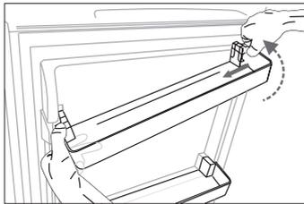
Drücken Sie die rechte Seite der Türablagen nach innen, während Sie die linke Seite der Türablage festhalten. Entfernen Sie die Türablage, sobald diese aus der Kerbe herauspringt, indem Sie sie schräg nach oben ziehen.
