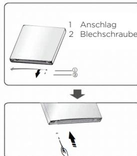
7. Lösen Sie die Blechschrauben, mit denen das mittlere Scharnier befestigt ist; entfernen Sie nun das mittlere Scharnier, das den unteren Teil der Tür hält.
