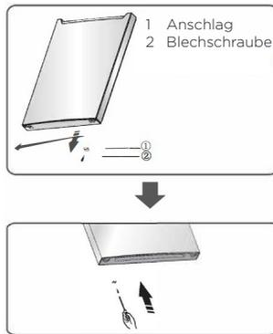
9. Versetzen Sie die Stopfen bzw. Abdeckungen an der Frontseite der Trennwand zwischen dem Kühl- und Gefriereteil von der linken auf die rechte Seite (siehe Abbildung unten).
