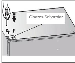
16. Stecken Sie die Stopfen in die Bohrungen an der rechten oberen Ecke des Kühlteils ein. Stecken Sie die Abdeckung des oberen Scharniers ein (aus dem Plastiktüte) an der linken Seite des Geräts ein. Bewahren Sie die Abdeckung des oberen Scharniers in der Plastiktüte auf.
