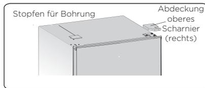
3. Lösen Sie die Blechschrauben, mit denen das obere rechte Scharnier befestigt ist, mit einem 8 mm-Steckschlüssel; halten Sie dabei mit der Hand die Gerätetür, um deren Gewicht zu entlasten).
