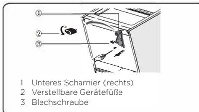
11. Versetzen Sie das untere Scharnier auf die linke Seite und befestigen Sie es mit den Blechschrauben. Schrauben Sie wieder die verstellbaren Gerätefüße auf der anderen Seite ein und befestigen Sie sie.
