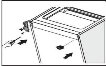
12. Setzen Sie die untere Tür in der entsprechende Position ein. Stellen Sie die Position des unteren Scharniers ein, setzen Sie die Achse des Scharniers in die untere Bohrung der Tür ein und schrauben Sie die Schrauben fest.
