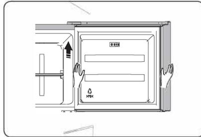
6. Legen Sie die obere Tür auf eine glatte Unterlage mit der Außenfläche nach oben. Lösen Sie die Schraube (2) und den Teil (1); versetzen Sie diese dann auf die linke Seite und befestigen Sie sie.
