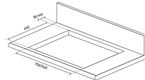
Für den flächenbündigen Einbau umlaufend min. 1,8 mm für die Silikonfuge berücksichtigen. Falzhöhe 7 mm
