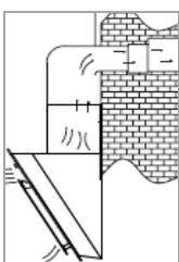
Als er een leiding onder de bovenkasten zit, kan het afvoerkanaal zo worden gelegd dat de afgezogen lucht horizontaal door de wand kan worden afgevoerd.
