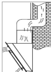
Odciągane powietrze jest normalnie odprowadzane pionowo. Odciągane powietrze może być odprowadzane przez jednostki ścienne i podłożę stropu do kuchenicy.
