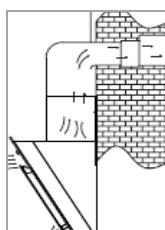
Jeżeli pod jednostkamiściennymi znajduje się przewód, przewód wyciągowy można poprowadzić w taki sposób, aby wywiane powietrze mogło być wypuszczane poziomo przez ścianę.
