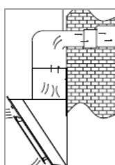
Falls eine Leitung unter den Oberschränken vorhanden ist, kann der Abzugsschacht so verlegt werden, dass die Abluft waagerecht durch die Wand abgeleitet werden kann.
