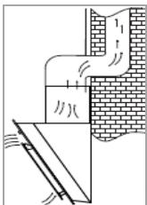
Gewoonlijk wordt de uitlaatlucht verticaal afgevoerd. De afvoerlucht kan via de wandunit en de zolder naar de dakheer worden geleid.
