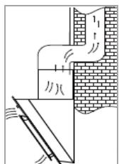
L'air extrait est normalement évacué verticalement. L'air extrait peut être évacué à travers les éléments hauts et le plancher du grenier jusqu'au faîte du toit.
