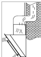
Meist wird die Abluft vertikal abgeführt. Die Abluft kann durch den Oberschränk und Dachboden zum Dachfürst geleitet werden.
