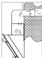
S'il y a un conduit sous les éléments hauts, le conduit d'extraction peut être acheminé de manière à ce que l'air extrait puisse être évacué horizontalement à travers le mur.
