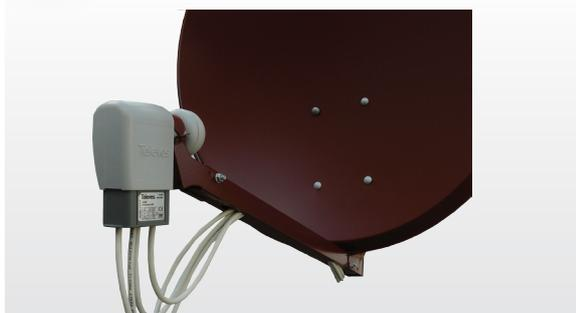
LNB einlegen und mit Feedhalter fixieren. Bis zu 4 Koaxialkabel können im Inneren des Feedarms durchgeführt werden.
