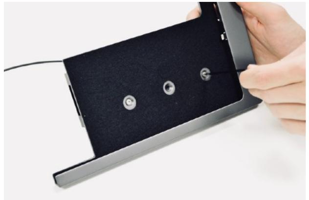
**Schritt 3.2** Setzen Sie die Verriegelungsschiene auf. Die Seite mit den angesenkten Schraubenlöchern zeigt nach oben. Befestigen Sie die Verriegelungsschiene anschließend mit den beiliegenden Schrauben (benötigtes Werkzeug: 2mm Innensechskantschlüssel). Befestigen Sie schlussendlich wieder die Rückenplatte am free flex Rahmen.
