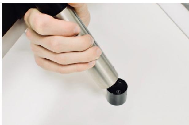
Schritt 1.5 Befestigen Sie des Standrohr, indem Sie die Schraube im Schraubsockel nach rechts drehen. Werkzeug: 4mm Innensechskantschlüssel.
