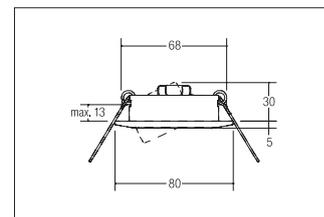
Deckeneinbau-Lautsprecher, DA 68 mm, nickel, rund. Ausgeführt in kompakter Bauform für werkzeuglose Schnellmontage zum Deckeneinbau. Nenn- / Musikbelastbarkeit: 3 / 4 W, Impedanz: 20 Ohm
