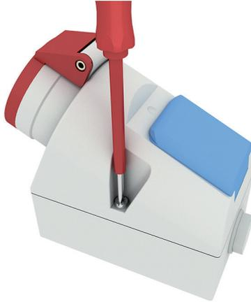
5. Bei Varianten ohne Verdrahtung: Stellen Sie die erforderlichen Verbindungen innerhalb der Wandsteckdose gemäß einer der drei möglichen Anschlussmöglichkeiten her und prüfen Sie sie. Ziehen Sie die Schrauben an den Anschlussklemmen (7) mit mindestens 1,2 Nm fest.
