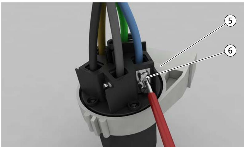
9. Prüfen Sie durch leichtes Ziehen, ob die Einzelleiter fest sitzen. Sollte das nicht der Fall sein, öffnen Sie die Klemme und wiederholen Sie den vorhergehenden Schritt.
