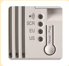
⚠ Die „US“-LED blinkt regelmäßig, wenn Netz (230 V) und EIB Bus-Spannung aktiv am Gerät angeschlossen sind. Das Gerät ist betriebsbereit, wenn die „US“-LED blinkt.
