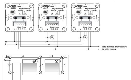
1, 2, 3 = Interrupteur du volet roulant
