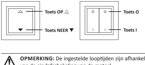
**OPMERKING:** De ingestelde looptijden zijn afhankelijk van de eindafschakeling van de motor!
