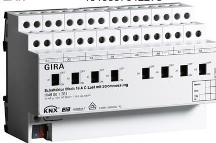
REG-Schaltaktoren mit integrierter Busankopplung. Zum Schalten von unabhängig ansteuerbaren Lastgruppen. Mit Handschalter zur Umschaltung des Relais (Ein Aus) parallel bzw. ohne KNX Betrieb. Anschluss mehrphasig. Keine zusätzliche Spannungsversorgung erforderlich.
