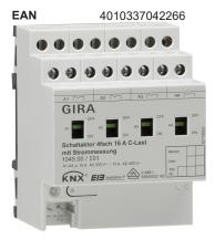
REG-Schaltaktoren mit integrierter Busankopplung. Zum Schalten von unabhängig ansteuerbaren Lastgruppen. Mit Handschalter zur Umschaltung des Relais (Ein Aus) parallel bzw. ohne KNX Betrieb. Anschluss mehrphasig. Keine zusätzliche Spannungsversorgung erforderlich.
