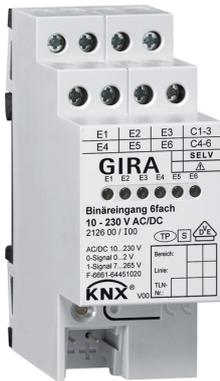
REG-Binäreingänge zum Anschluss von Kontakten. Die Schaltvorgänge von Kontakten (z. B. Wächter bzw. Taster) werden in KNX Telegramme umgesetzt. Die Eingänge können dabei unabhängig voneinander verschiedenen Funktionen zugeordnet oder gesperrt werden. Signalanzeige über gelbe Status-LED möglich.
