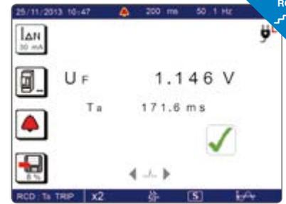
Mit der FI-Schutzschalterprüfung lässt sich auch die Fehlerspannung  $U_f$  berechnen:  $U_f = Z_s \times I_{\Delta n}$
