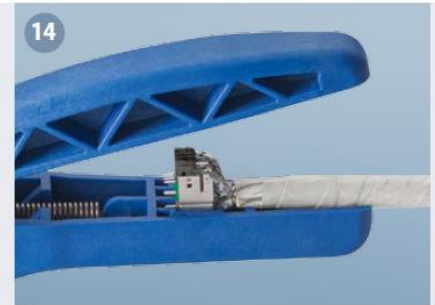
14 Wire Manager mit der Modulverpresszange verpressen. Press the wire manager together by using the combination pliers.
