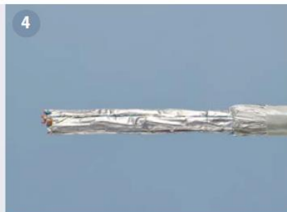
4 Bündelverseilung aufdrehen. Untwist the pairs.
