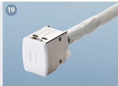
19 Verpresshilfe als Schutzkappe belassen... Leave fit-up aid as protection cap...
