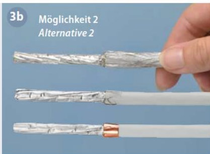
3b Möglichkeit 2 Alternative 2 Alternativ Schirmgeflecht zurückschieben, auf 5 mm kürzen und mit selbstklebender Kupferfolie fixieren. Alternatively push back the copper braid, cut it to 5 mm and fix it with self-adhesive copper foil.
