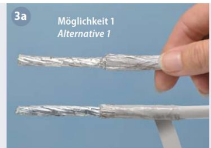
3a Möglichkeit 1 Alternative 1 Schirmgeflecht zurückschieben und mit Isolierband fixieren. Push back the copper braid and fix it with tape.
