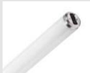
Leuchtstofflampe T12 37x590 mm Leuchtstofflampe T12, schwarzlicht/bl, für Insektenvernichter geeignet. Lampe emittiert UV-Strahlung im Bereich 315-400nm mit einem Maximum bei 352nm. Anwendungsbereiche sind Insektenfallen, Diazotypie (Lichtpausverfahren), Chemische Prozesse, z.B. Polymerisation, Erkennung von Mineralien und Lack- und Klebertrocknung. Vorteil dieser Lampe: Äquivalent mit anderen Leuchtstofflampen bezüglich elektrischer und physikalischer Eigenschaften.
