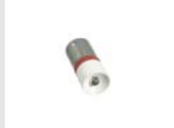
Single-LED 10x25mm Retrofit, als Ersatz für herkömmliche Glühlampen in Handwerk und Industrie. Gesockelte, super helle LED in gelb, mit Brückengleichrichter AC - Die LED ist zum direkten Anschluss an die Versorgungsspannung 115-130VAC dimensioniert. Mittels handelsüblicher Lampenfassungselemente mit integriertem Vorwiderstand ist nicht zulässig.
