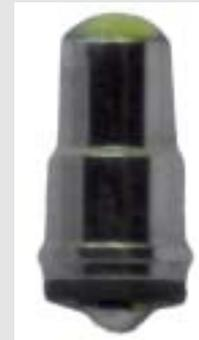
Chip-LED bipolar 5,6x15,8mm Spezielle Kombination aus Reflektor und Streulinse. Dadurch wird eine Abstrahlcharakteristik ähnlich einer Mehr-Chip LED erreicht. Zwischen Reflektorelement und Sockel ist zur Realisierung der Bauhöhe ein Isolierteil in Leuchtfarbe der LED eingebaut. Innenraum im Bereich der Kunststoffteile zur verbesserten Wärmeabfuhr vergossen. Keine UV/IR-Strahlung.
