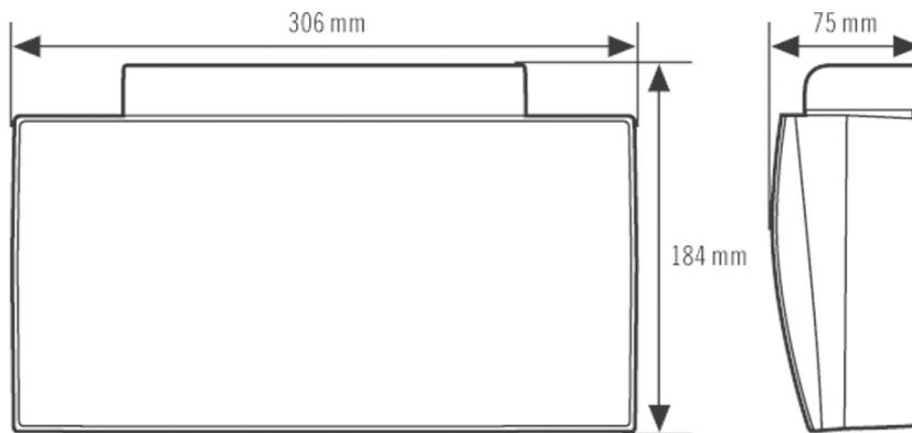
**Einzelbatterie-Notleuchten Serie SLC, SLD, SLE, SLF und SLG mit Fail-Safe Kontakt**
