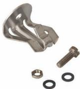
FR 100FR 200FR 500SiPLAST® 98SiPLAST® frei strahlendGfK-MontageschieneFR-Leuchte - Ex-Ausführung, Universal-Leuchtenabänger, Deckenbefestigungselement, aus Edelstahl (V2A), unbehandelt, Traglast (Abhängung): Tragkraft 25kg, Verpackungseinheit: 1 Stück
