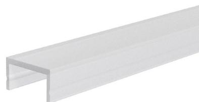
Abdeckung passend für verschiedene Aluminiumprofile. Durch die gefrostete Abdeckung sind die darunterliegenden Bauteile kaum sichtbar, während gleichzeitig bei nur geringem Lichtverlust eine Entblendung erreicht wird. Technische Daten: Material: UV-beständiges PMMA, Transmissionsgrad: ca. 80%
