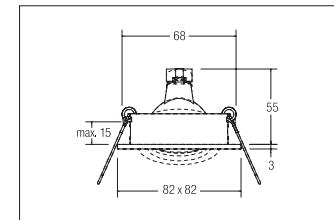
Einbaustrahler, chrom, quadratisch. Ausgeführt in kompakter Bauform für werkzeuglose Schnellmontage zum Deckeneinbau. Fassung: GX5,3, Montageart: Einbaumontage, Montageort: Deckenmontage, Material: Aluminium, Schutzart: nach DIN EN 60529: IP20, Schutzklasse: (EN 61140) III, Spannung: 12V, Leistung: max. 50W, Anzahl der Leuchtmittel / Fassungen: 1.0 Stk, Verstellbarkeit: schwenkbar, ohne Betriebsgerät, Art der Dimmung: sonstige, .
