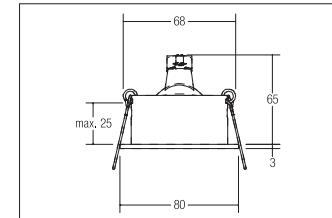
Einbaustrahler, weiß. Ausgeführt in kompakter Bauform für werkzeuglose Schnellmontage zum Deckeneinbau. Fassung: GX5,3, Montageart: Einbaumontage, Montageort: Deckenmontage, Material: Aluminium, Schutzart: nach DIN EN 60529: IP20, Schutzklasse: (EN 61140) III, Spannung: 12V, Leistung: max. 50W, Anzahl der Leuchtmittel / Fassungen: 1.0 Stk, Verstellbarkeit: schwenkbar, ohne Betriebsgerät, Art der Dimmung: sonstige, .
