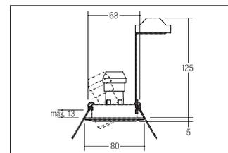
Hochvolt-Einbaustrahler GU10, weiß, rund. Ausgeführt in kompakter Bauform für werkzeuglose Schnellmontage zum Decken-einbau. Inkl. Hochvoltbügel zur normgerechten Zugentlastung. Fassung: GU10, Montageart: Einbaumontage, Montageort: Deckenmontage, Material: Stahl, Schutzart: nach DIN EN 60529: IP20, Schutzklasse: (EN 61140) II, Spannung: 230V AC 50Hz, Leistung: max. 50W, Anzahl der Leuchtmittel / Fassungen: 1.0 Stk, Verstellbarkeit: schwenkbar, Art der Dimmung: sonstige, .
