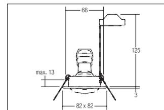
Hochvolt-Einbaustrahler GU10, nickel, quadratisch. Ausgeführt in kompakter Bauform für werkzeuglose Schnellmontage zum Deckeneinbau. Inkl. Hochvoltbügel zur normgerechten Zugentlastung. Fassung: GU10, Montageart: Einbaumontage, Montageort: Deckenmontage, Material: Stahl, Schutzart: nach DIN EN 60529: IP20, Schutzklasse: (EN 61140) II, Spannung: 230V AC 50Hz, Leistung: max. 50W, Anzahl der Leuchtmittel / Fassungen: 1.0 Stk, Verstellbarkeit: schwenkbar, Art der Dimmung: sonstige, .
