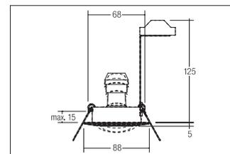
Hochvolt-Einbaustrahler GU10, gold, rund. Ausgeführt in kompakter Bauform für werkzeuglose Schnellmontage zum Deckeneinbau. Inkl. Hochvoltbügel zur normgerechten Zugentlastung.
