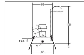
Hochvolt-Einbaustrahler V4A GU10, edelstahl, rund. Ausgeführt in kompakter Bauform für werkzeuglose Schnellmontage zum Deckeneinbau. Inkl. Hochvoltbügel zur normgerechten Zugentlastung. Fassung: GU10, Montageart: Einbaumontage, Montageort: Deckenmontage, Material: Edelstahl, Schutzart: nach DIN EN 60529: IP20, Schutzklasse: (EN 61140) II, Spannung: 230V AC 50Hz, Leistung: max. 50W, Anzahl der Leuchtmittel / Fassungen: 1.0 Stk, Verstellbarkeit: schwenkbar, Art der Dimmung: sonstige, .
