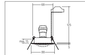
Hochvolt-Einbaustrahler GU10, chrom, rund. Ausgeführt in kompakter Bauform für werkzeuglose Schnellmontage zum Deckeneinbau. Inkl. Hochvoltbügel zur normgerechten Zugentlastung.
