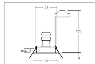
Hochvolt-Einbaustrahler GU10, chrom, rund. Ausgeführt in kompakter Bauform für werkzeuglose Schnellmontage zum Decken-einbau. Inkl. Hochvoltbügel zur normgerechten Zugentlastung. Fassung: GU10, Montageart: Einbaumontage, Montageort: Deckenmontage, Material: Stahl / Messing, Schutzart: nach DIN EN 60529: IP20, Schutzklasse: (EN 61140) II, Spannung: 230V AC 50Hz, Leistung: max. 50W, Anzahl der Leuchtmittel / Fassungen: 1.0 Stk, Verstellbarkeit: schwenkbar, Art der Dimmung: sonstige, .
