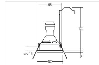
Hochvolt-Einbaudownlight GU10 IP65, chrom, rund. Ausgeführt in kompakter Bauform für werkzeuglose Schnellmontage zum Deckeneinbau. Inkl. Hochvoltbügel zur normgerechten Zugentlastung. Fassung: GU10, Montageart: Einbaumontage, Montageort: Deckenmontage, Material: Guss / Glas, Schutzart: nach DIN EN 60529: IP65\*, Schutzklasse: (EN 61140) II, Spannung: 230V AC 50Hz, Leistung: max. 50W, Anzahl der Leuchtmittel / Fassungen: 1.0 Stk, Verstellbarkeit: nicht verstellbar, Art der Dimmung: sonstige, .
